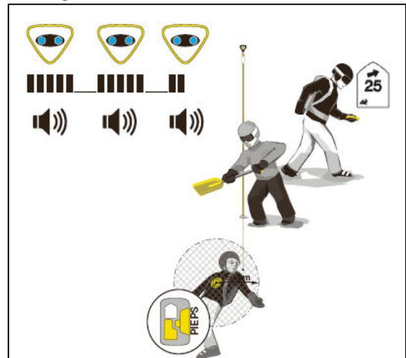
Nach Deaktivierung des Sende-LVS wird am Empfänger-LVS das nächst stärkste Signal angezeigt. Der suchende Retter verfolgt unmittelbar das neue Signal, während übrige Retter mit dem Schaufeln beginnen.
